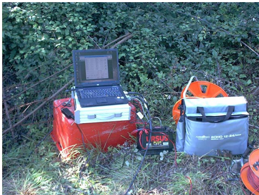
Foto n.1 - Sismografo ECHO 12-24/2002 in configurazione di campagna.
